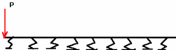
fig 1 : semelle infinie sur appui elastique Cas charge ponctuelle
